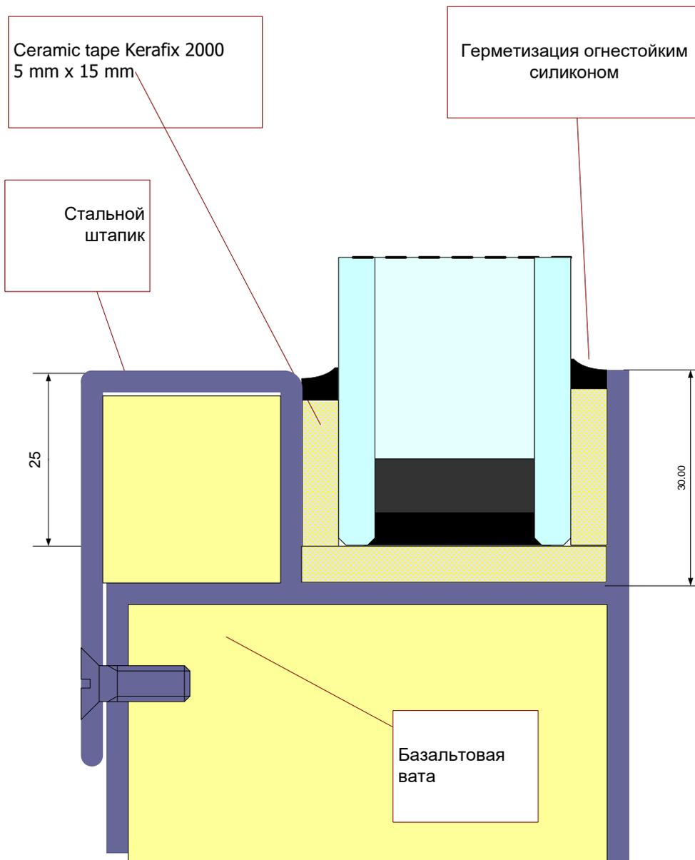
*Рисунок 2.* Пример монтажа пожаростойкого стекла в противопожарной двери. Толщина негорючей теплоизоляции для обеспечения огнестойкости 60 минут должна быть не менее 5мм, для огнестойкости 30 минут достаточна толщина прокладки 3мм.
